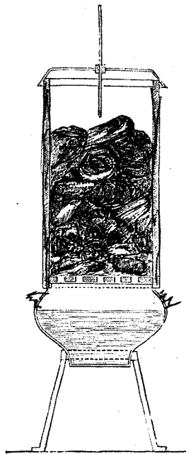
Рис. 2. Вертикальный разрѣзъ. Рис. 1 и 2. Простѣйшая паровая дезинфекціонная камера проф. М. И. Капустина.
